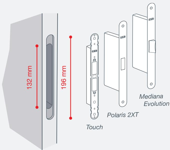
В специализированных дверях для Touch требуется неглубокая фрезеровка, затрагивающая только обвязку двери.
